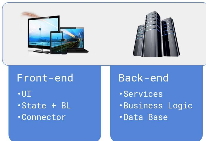
As aplicações web têm dois componentes, o front-end que é executado no navegador web e o back-end que é executado em um servidor web.
