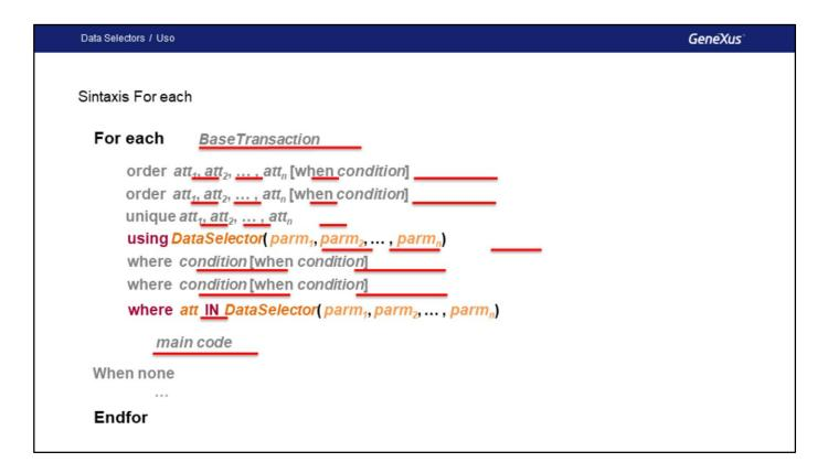
Un Data Selector especifica, en base a los parámetros recibidos, un conjunto de condiciones y ordenamientos para la información de manera centralizada, de modo de no tener que repetir las cláusulas order, where y defined by en cada lugar en que se necesiten.
