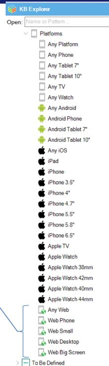
Estas nuevas plataformas web agregadas al nodo Platforms del KB Explorer, permiten diseñar layout que sean específicos para ejecutar aplicaciones web en distintos dispositivos con diferentes tamaños de pantalla, desde teléfonos hasta computadoras de escritorio.
