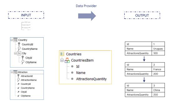
Para representar este ejemplo, creamos la siguiente estructura de datos que será la que posteriormente devuelva el Data Provider. Y luego debemos cargar este objeto SDT dentro del Source del Data Provider.
